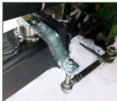
STR-707 Elektronisk styrning (EPS) som levererar enastående köregenskaper.
