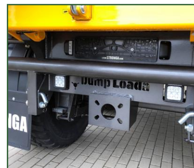
STR-1002 Monteringsplatta för VBG inkl broms och 7-poligt uttag.
