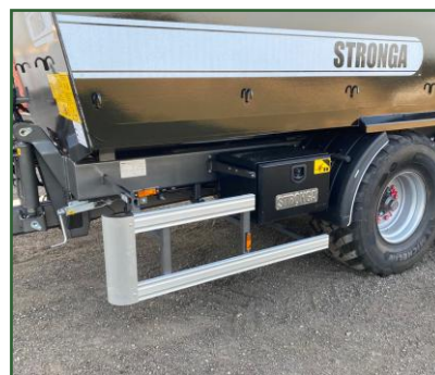
STR-1001 Väldigt lätta, extra starka sidopåkörningsskydd.
