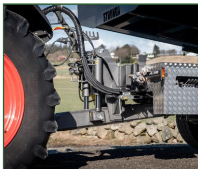
STR-508 Hydrauliskt avfjädrat drag för lätt nivellering av vagnen i kombination med förbättrad förarkomfort.
