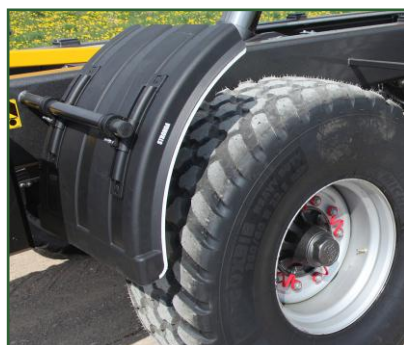
STR-903 Stänkskärmar av hårdplast fram och bak.
