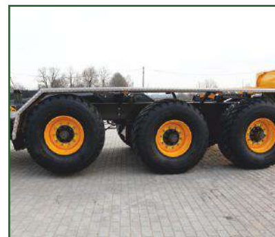
STR-411 Fremre løfteaksel - kun tilgjengelig med luft- eller hydraulikkfjæring.
