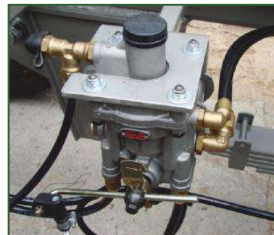
STR-304 Lastfølende ventil (LSV) for luftbremses.
