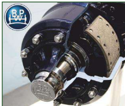
STR-211 BPW autosentrerende fristyrende for aksel, 420x180 bremseaksler, 120x120 mm kvadratisk bjelke.
