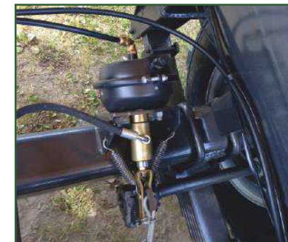
STR-305 Dobbelt luft- og hydraulisk bremsesystem.
