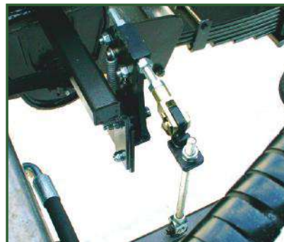
STR-302 Lastfølning for hydrauliske bremses.
