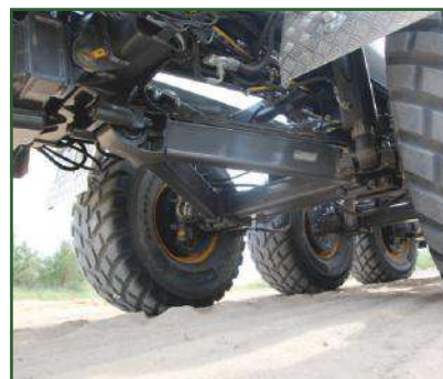
STR-410 Hydraulisk fjæring for optimal akselvandring. Utviklet for tynge bruksområder, både på og terreng.
